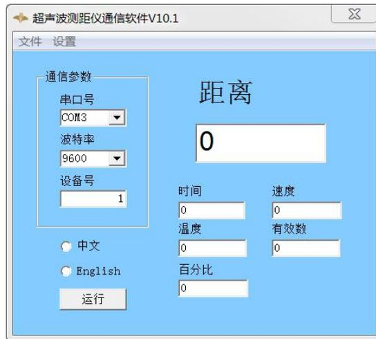
软件主界面上显示“串口号”，“波特率”，“设备号”三个通信参数。在使用软件访问设备前，需要先设置此三个参数。
