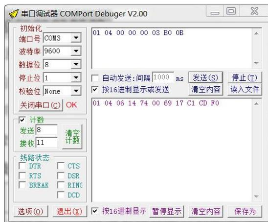
设备应答的数据是 16 位有符号整形数据，需要换算为 10 进制后加上表中的单位就是测量实际值。其中 0x1474 代表飞行时间  $t=5236/1.44=3636.11\mu\text{s}$ ；0x0069 表示内部温度  $T=105*0.0625=6.5625^\circ\text{C}$ ；0x17C1 表示距离  $L=6081*0.1=608.1\text{mm}$ 。0xCDF0 是 CRC 校验值。
