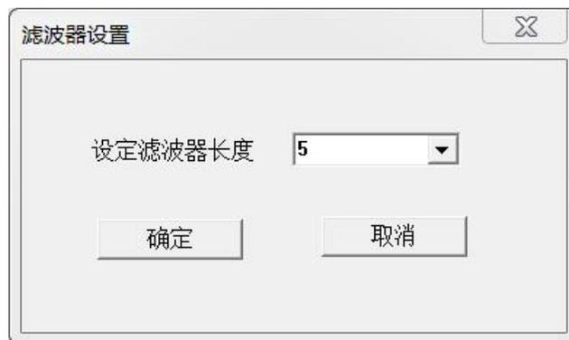
测距仪内置一个数字窗口滤波器，其计算方法为当前采集的距离值与前  $N-1$  个值，去除采集到的异常点以后，累加求平均。滤波窗口大小  $N$  可以通过软件进行设置，设置范围为  $1\sim 10$ （出厂设置为  $5$ ）。当设置为  $1$  时，产品直接输出原始数据，不进行滤波计算。
